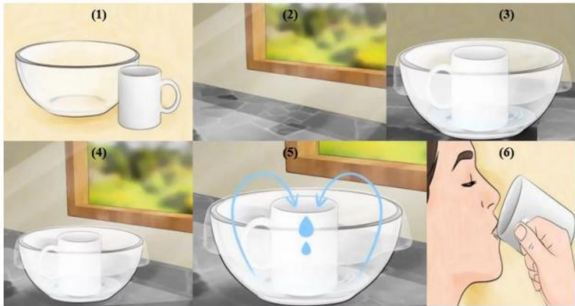
Gambar 2. Ilustrasi proses desalinasi sederhana
