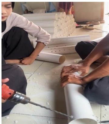
Gambar 3.3 Pengeboran Pipa Biopori
