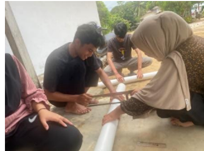
Gambar 3.2 Pemotongan Pipa Biopori
